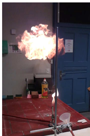
Foto: Mehlstaubexplosion im Rahmen des Projekts „Gefahren im Haushalt“
